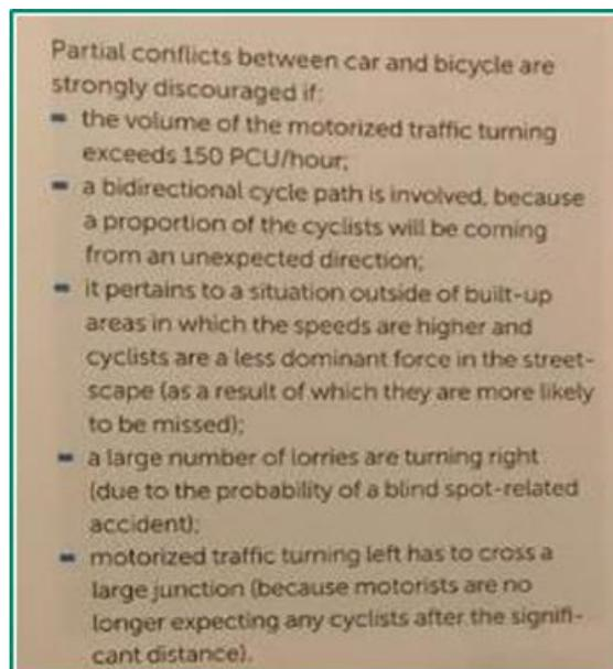
**Figure 2.4.3 Extract from Dutch Design Guide Ontwerpwijzer Fietsverkeer**
